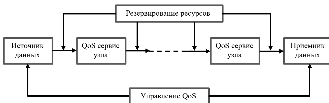
Рис. 1. Общая схема обеспечения качества обслуживания в программно-конфигурируемых сетях.
