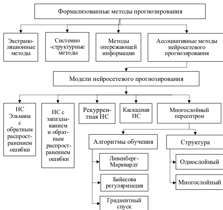
Рис. 2. Методы и модели нейросетевого прогнозирования
