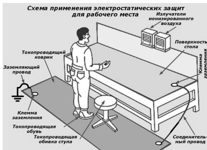
Рис. 1. Схема применения электрических защит для рабочего стола.
