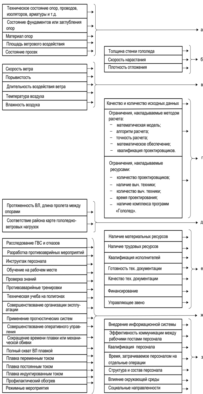
Рис. 2.а. Диаграмма связей внешних факторов, системообразующих факторов и критериев надежности и эффективности ЭЭС при ГВС
